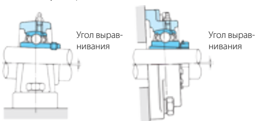
Рис. 1. Допустимый угол выравнивания подшипникового узла
