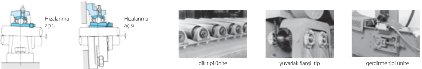
Şekil 1 Rulman yatağında izin verilen hizalama açısı
