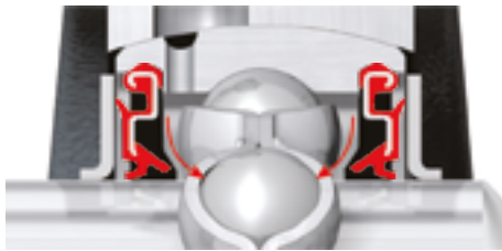
Fig. 3: Yağlamanın kolaylaştırılması için yeni conta modeli
