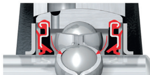
Fig. 3: Nuevo diseño del retén para la lubricación
