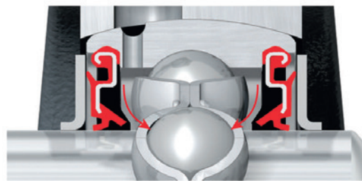
Fig. 3: Un nou design al garniturilor pentru lubrifiere
