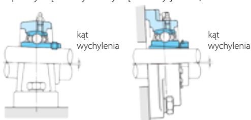
Rys. 1 Dozwolony kąt wychylenia zespołu łożyska kulkowego
