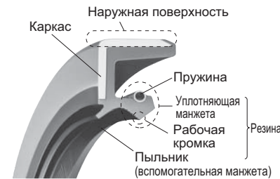
Рис. 14-8 Названия элементов масляного уплотнения
